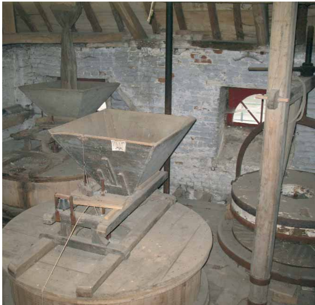
Zicht op het nog niet gerestaureerde interieur van de molen anno 2010. Er zijn drie maalstoelen , een graankuiser en een builmolen aanwezig.
